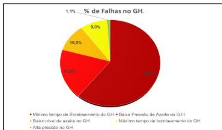
Figura 4. Falhas no grupo hidráulico (GH). Fonte elaboração própria.
